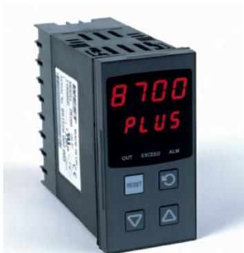
West 8700+ je programovatelná bezpečnostní limitní jednotka s certifikací. Má funkci blokování - aby proces mohl dále pokračovat, musí se limitní výstup resetovat. Kromě limitního může obsahovat i další signalizační a alarmové výstupy. Uživatelské rozhraní je optimalizované pro snadné použití.
